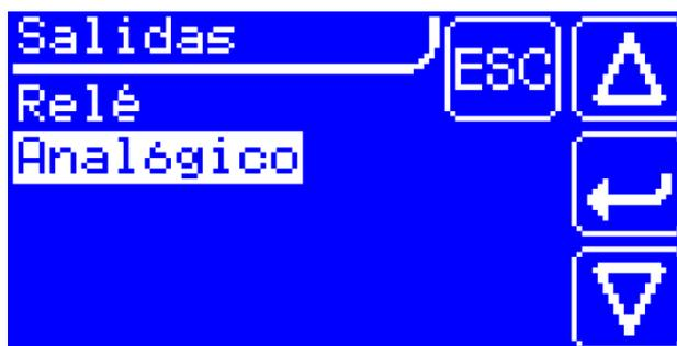
Si para el punto de medida se introduce un nº superior al 0, solo se visualizará el valor para ese punto de medida en la salida analógica.
