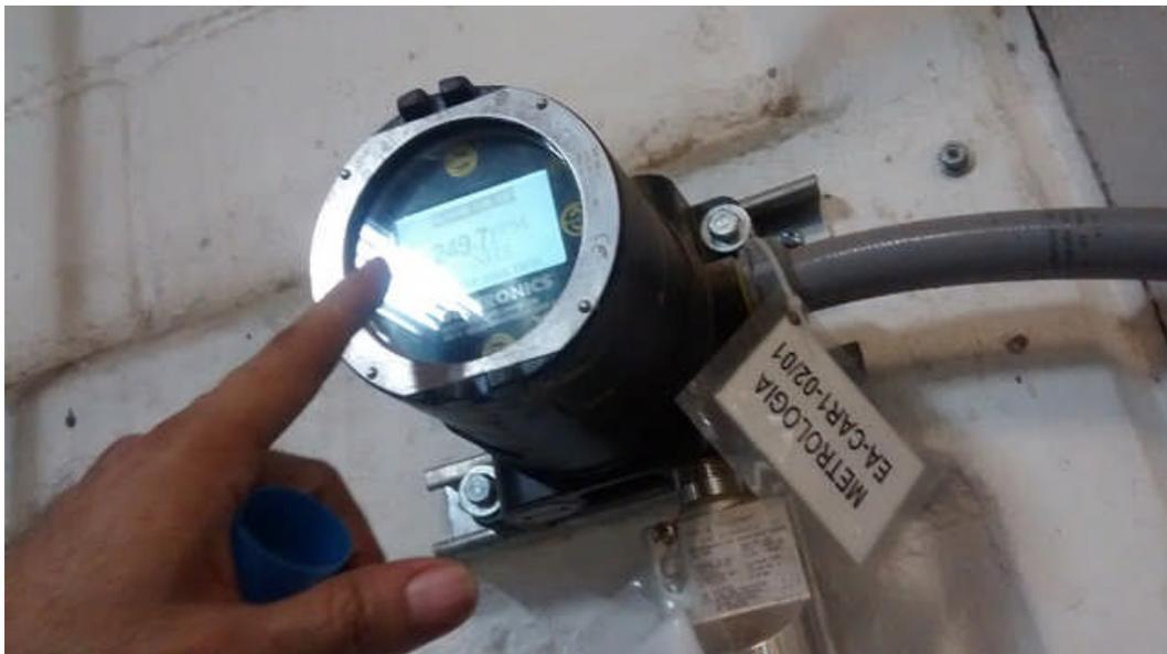
**EN EL CASO DE LINEA 5 SE ENCUENTRA DETECTOR EN FALLA Y FUE IMPOSIBLE REALIZAR SU CALIBRACION , LA FALLA DESCRITA ES NO HART EN PANTALLA Y SU MODULO TRANSMISOR NO ENCIENDE EL LED VERDE DE OPERACIÓN NORMAL , SE RECOMIENDA A PLANTA SU REEMPLAZO Y /O REPARACION , ESTE EQUIPO NO PASO SU PRUEBA DE CALIBRACION POR EL CUAL NO SE ENTREGA CERTIFICADO VIGENTE , EN ESTE EQUIPO SE COLOCA ETIQUETA ROJA POR MALA OPERACIÓN.**
